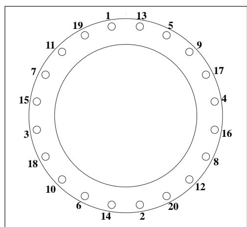
Un corretto serraggio delle flange garantisce, una perfetta tenuta della guarnizione (d) tramite gli anelli (a,b); e permette di avere un eguale distanza (c) tra i due anelli su tutta la circonferenza.
