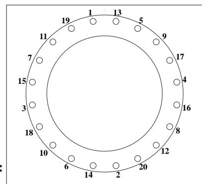
Das abschließende Anzugsmoment der beiden Flansche muss wie folgt sein:
