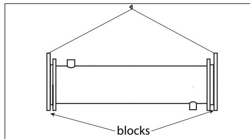
**⚠ Attenzione una volta tolti i fermi, mantenere l'aftercooler sempre in assetto orizzontale: inclinare l'aftercooler significherebbe pericolo di uscita e caduta del fascio tubiero o degli anelli di tenuta, con conseguente rischio per persone o cose.**
