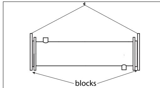
**⚠ Vorsicht! Sobald die Sicherheitsplatten entfernt sind, muss der Nachkühler stets in horizontaler Position bewegt werden.**
